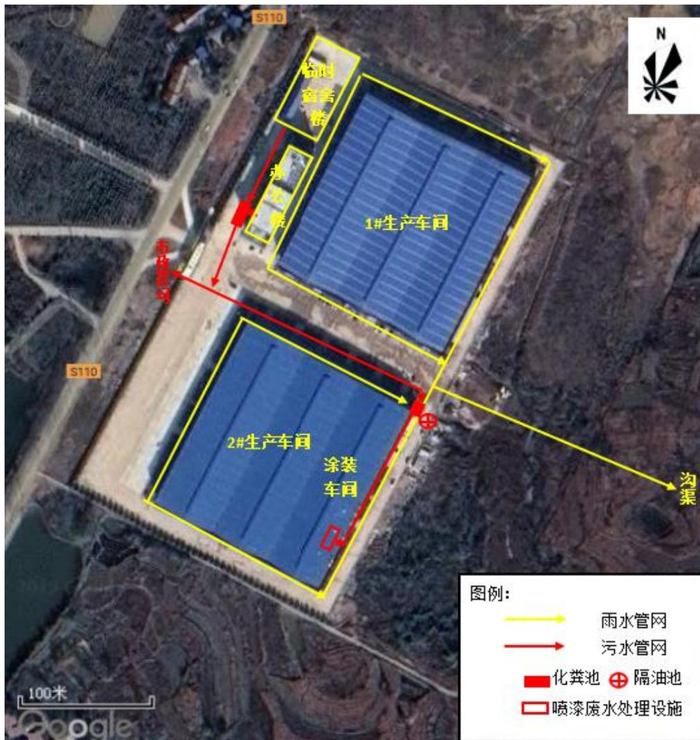
图 4-1 项目雨污分流管网图
