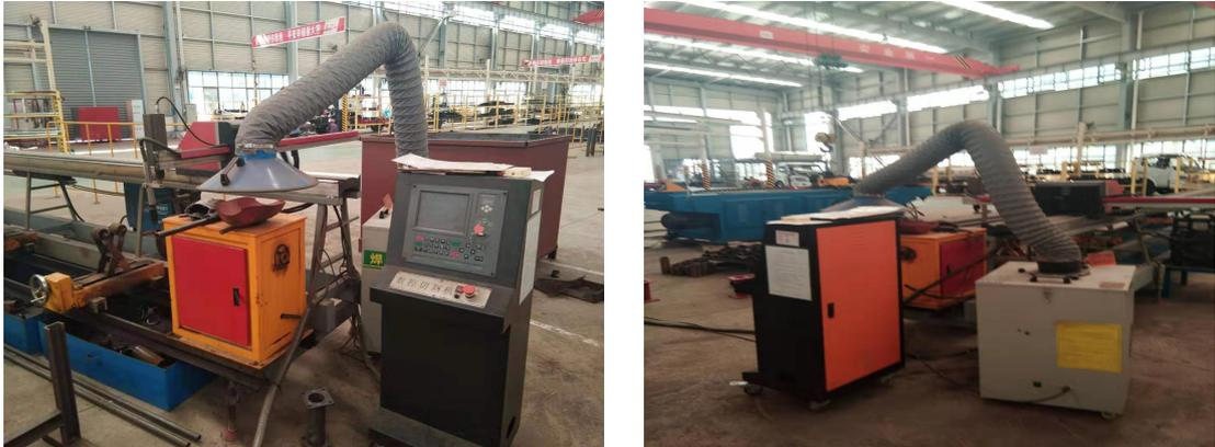
焊接岗位+移动式烟尘净化器
