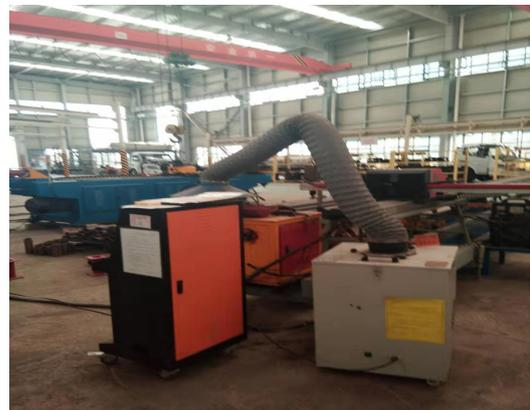
焊接岗位+移动式烟尘净化器
