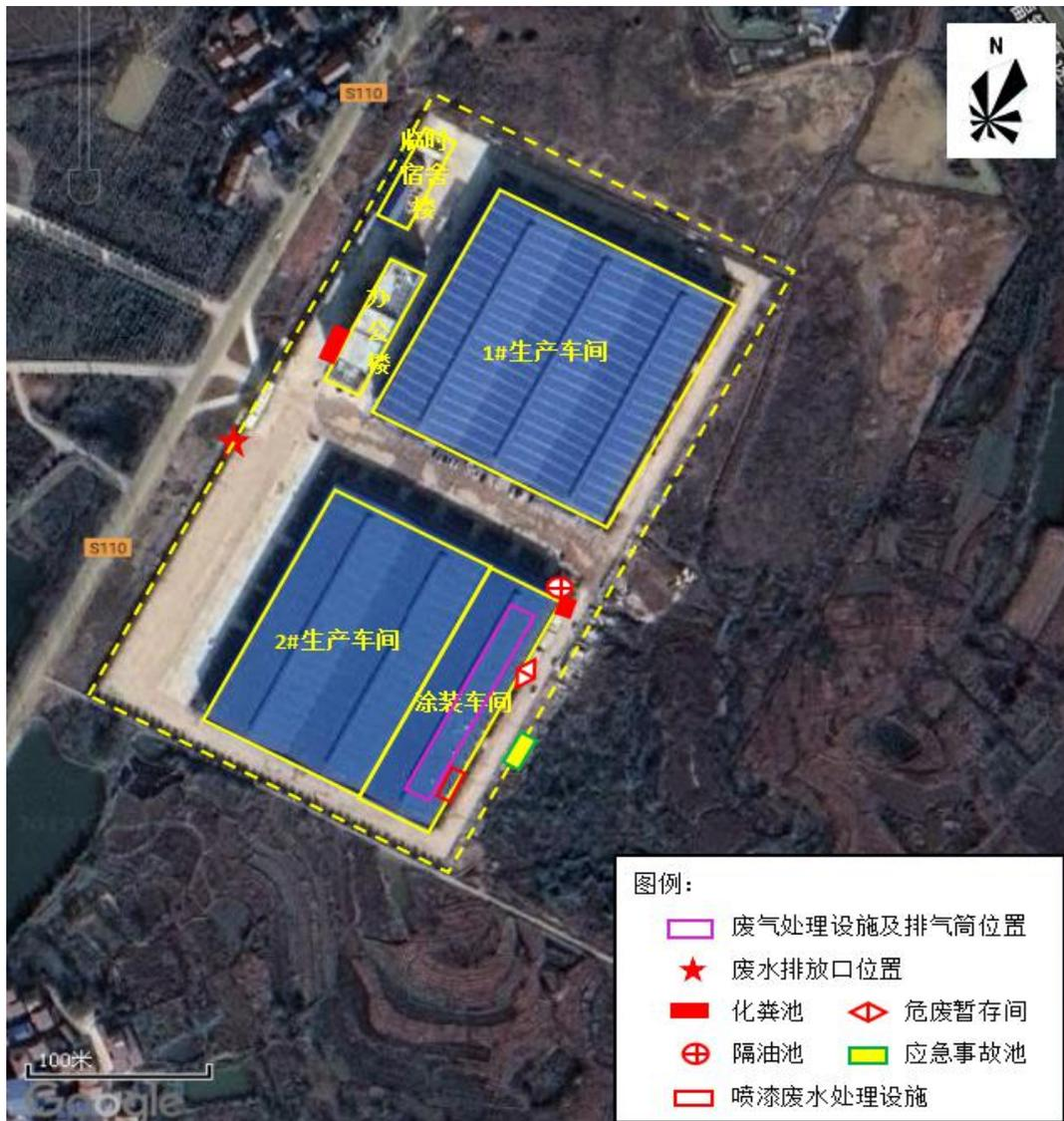
图 3-3 建设项目总平面布置图
